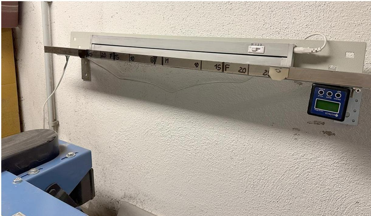
*Meine Messeinrichtung für den Kufensprung (an der Wand hinter der Schleifmaschine montiert) mit Lineal und Leuchtstofflampe. Rechts siehst Du meinen digitalen Neigungsmesser, mit dem ich nicht nur den Rake vom Mast, sondern auch die Tischneigung meiner Schleifmaschine sehr genau prüfen und einstellen kann.*
