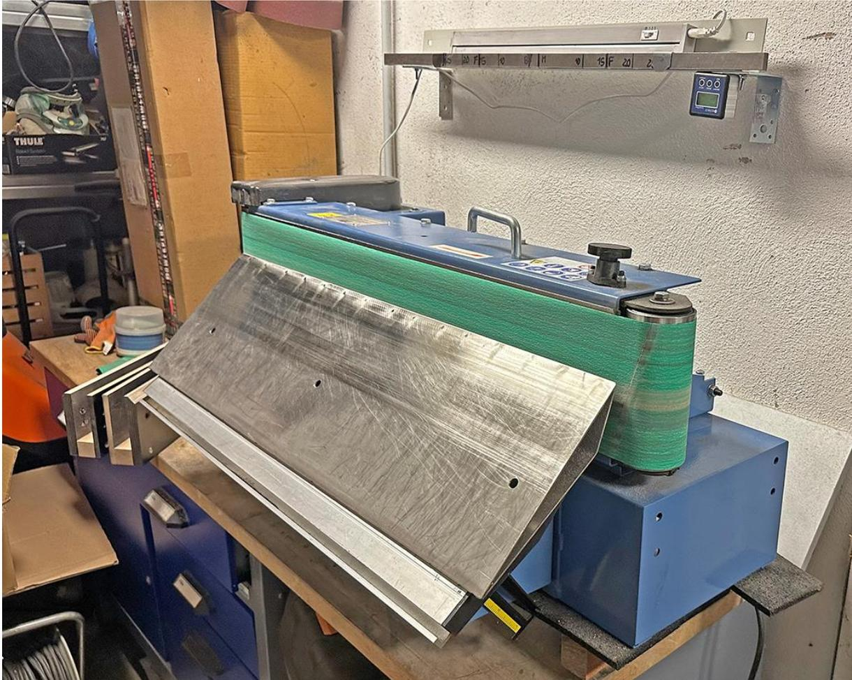
*Modifizierte HBM 200 mit aufgeschraubtem 10°-Keil aus VA-Blech und Keramik-Schleifband. Oberhalb der Maschine ist meine Kufensprungmessvorrichtung, links von der Maschine die beiden „Brackets“ zur Aufnahme meiner Kufen zu sehen.*
